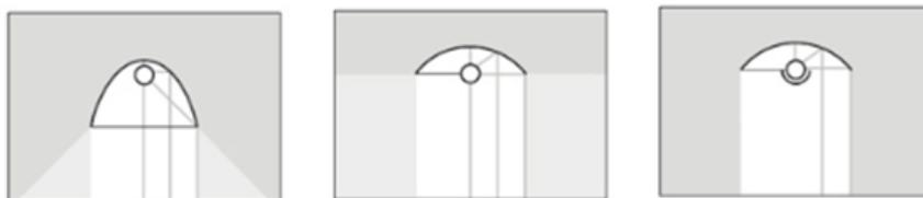
Рисунок 2.8 – Распределение потока излучения в зависимости от конструкции параболического отражателя
