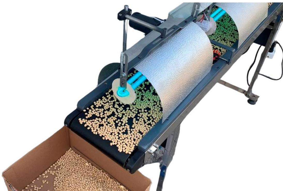
Рисунок 3.9 - Установка ультрафиолетовой обработки зерна в ходе лабораторных исследований
