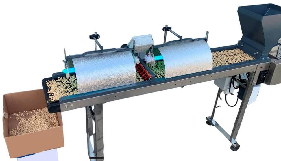
Рисунок 3.8 - Установка ультрафиолетовой обработки зерна в ходе лабораторных исследований
