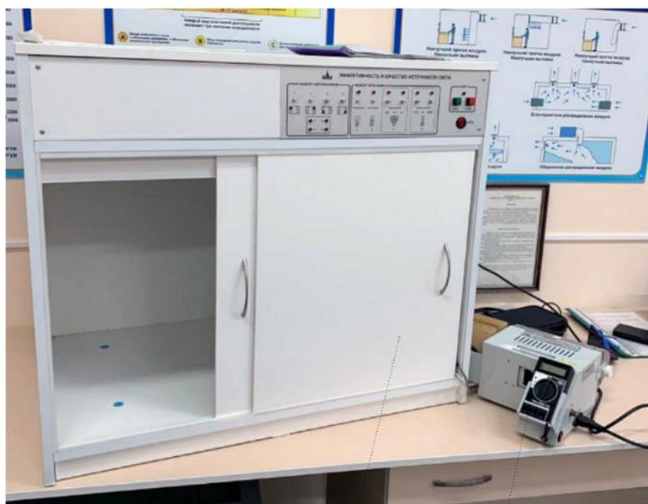
Рисунок 3.12 – Измерение энергетической освещённости
