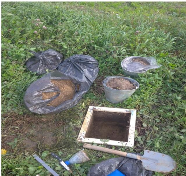
Рисунок 4 – Выкапывание монолита
