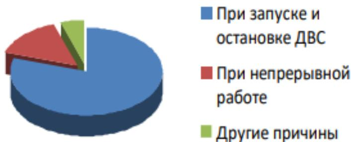
Рисунок 1.6 - Распределение отказов ТКР в зависимости от режима работы
