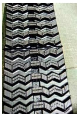
Рисунок 2.27 – РАГ типоразмера 450x86x56 (КНР) для заднего ТГМ:
