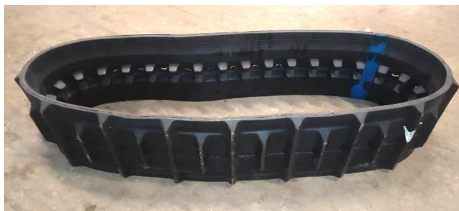
Рисунок 2.29 – РАГ типоразмера 280x80x34 (КНР):
