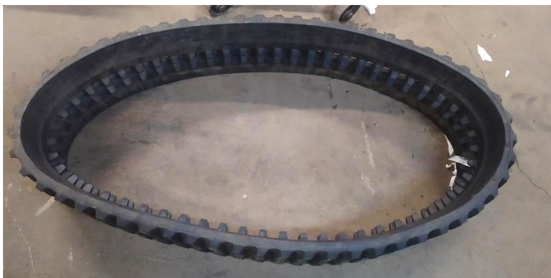
Рисунок 2.28 - РАГ типоразмера 450x86x56 (КНР) для заднего ТГМ (вид сверху)
