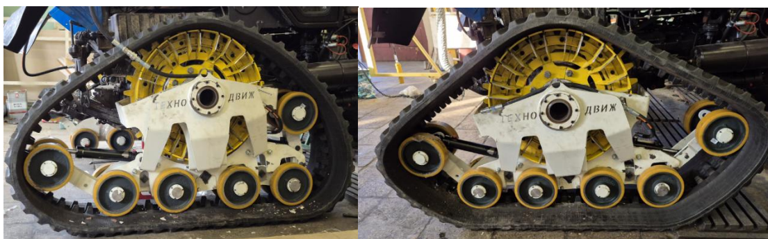
Рисунок 3.9 – Внешний вид свободного и натянутого состояния резиноармированной гусеницы:
