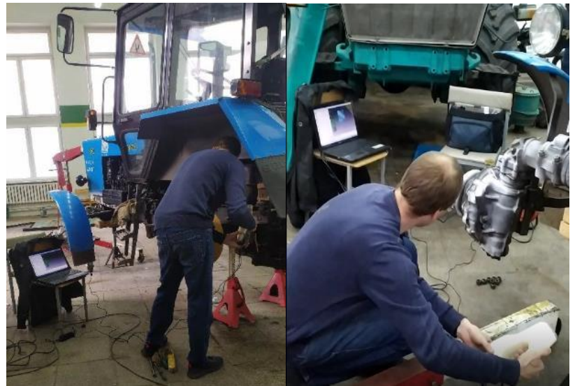
Рисунок 2.2 – Процесс подготовки и 3D-сканирования подкрыльного пространства: a - нанесение матирующего белого спрея; б - процесс сканирования
