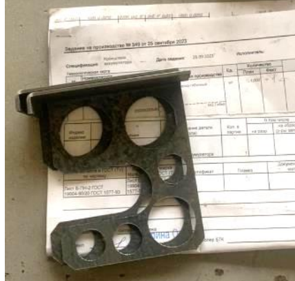
Детали крепления элементов гидроарматуры
