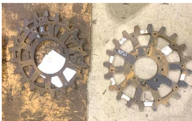
Зубчатые венцы ведущих колес и заготовки под них
