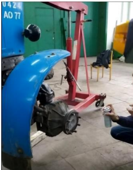
Рисунок 2.2 – Процесс подготовки и 3D-сканирования подкрыльного пространства: a - нанесение матирующего белого спрея; б - процесс сканирования
