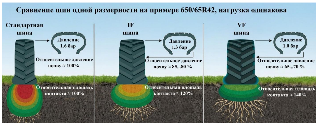
Рисунок 1.1 – Принципиальная схема уплотнения грунта колесным движителем
